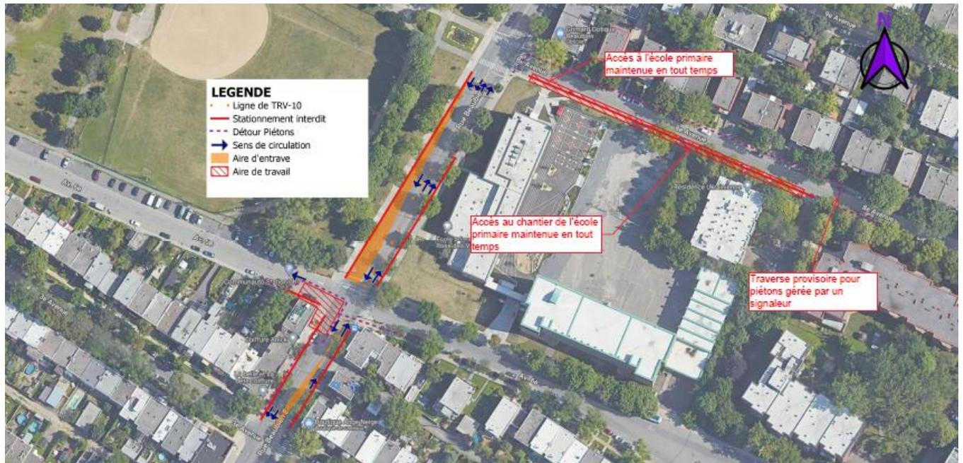
Travaux préparatoires, travaux de démolition et de reconstruction du puit d'accès à l'intersection Nord-Ouest de la rue Beaubien et de la 6<sup>e</sup> avenue, et reconstruction du massif de conduits sous le trottoir côté Ouest de la 8<sup>e</sup> Avenue, entre la rue Beaubien Est et l'adresse 6361, 8<sup>e</sup> Avenue.
